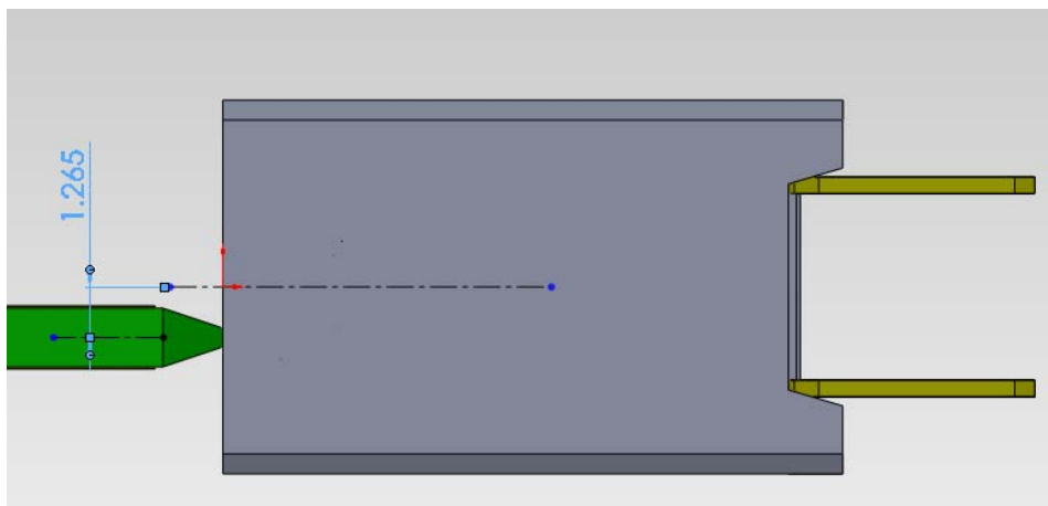
allowed misalignment in longitudinal axes 在縱向方向允許對插偏差量
